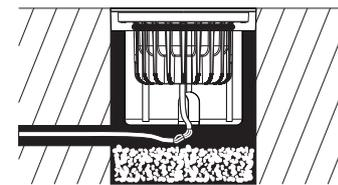
**ATENÇÃO!** O acabamento em **cobre** e o **latão**, em ambiente aberto sofrem com a ação do tempo e/ou por ataque químico, causando alterações na superfície podendo mudar de cor, ficando mais escura e eventualmente liberando fuligem que podem manchar a sua volta pedras porosas, tais como mármore e granito. Neste caso recomendamos sua aplicação apenas em decks de madeira ou pisos cerâmicos vitrificados.
